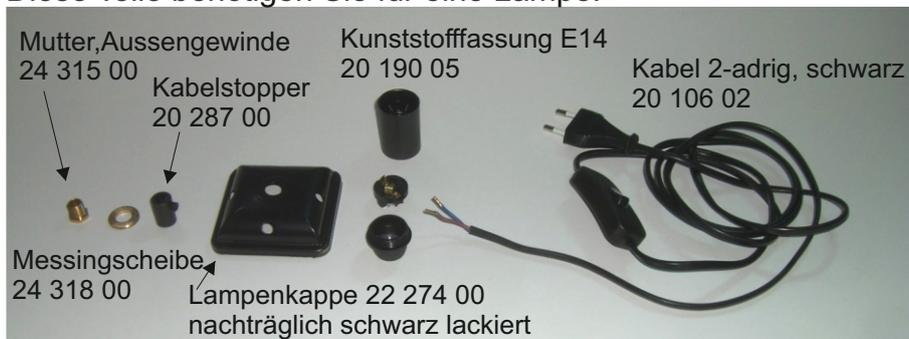
So werden die Einzelteile zusammgebaut:
