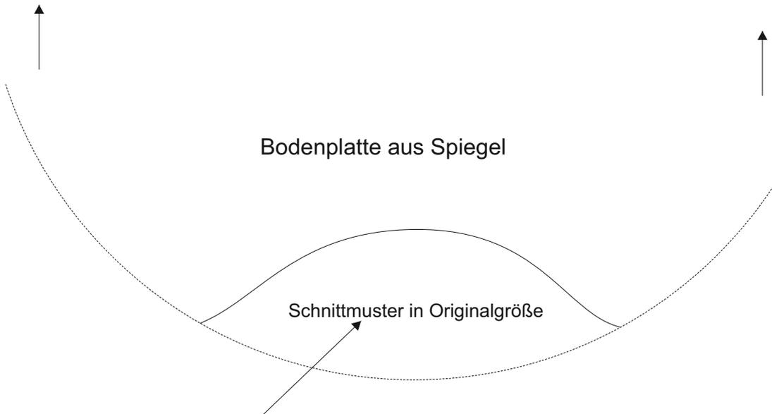
Diese Einbuchtung bildet später die Öffnung in der Bodenplatte
