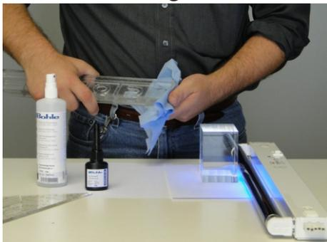
Reinigen Sie die Kontaktflächen mit einem speziellen Reiniger.
