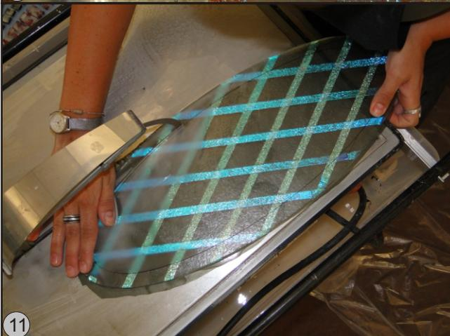
Diese hier genutzte Säge ( Gemini Revolution XT ) ist sicher das optimale Gerät - ist aber keine Grundvoraussetzung.
