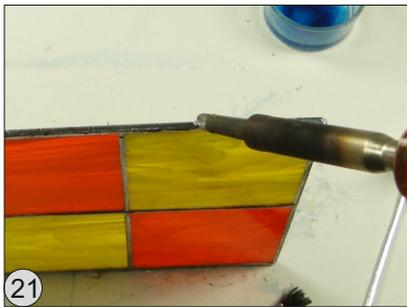
Ziehen Sie mit dem heißen Kolben und nur wenig Zinn die Metallstreifen aussen nach...
