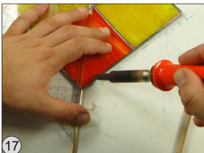
Zuerst fixieren Sie den Metallstreifen mit einen Lötunkt..
