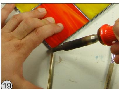
Am Schnittpunkt löten Sie mit etwas mehr Zinn. Lassen Sie die Verbindungsstelle mit Zinn volllaufen... Das erhöht die Stabilität.
