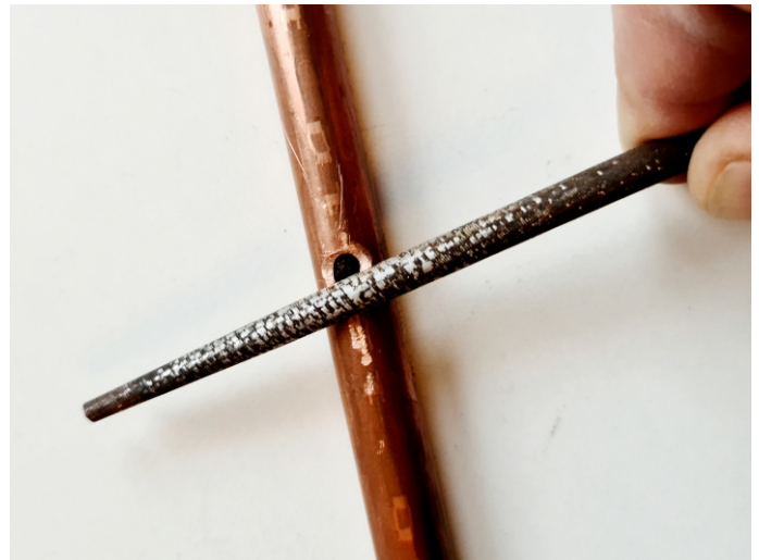
Das Kupferrohr wird ca. 25-30cm tief in den Boden gedrückt. Also feilen Sie knapp darüber eine Öffnung, durch die das Kabel eingefädelt werden kann.
