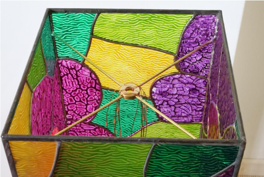
Für einen sauberen Abschluss und als stabilen Rand löten Sie oben umlaufend 4mm Messingrohr an. In den Ecken ist das Rohr auf Gehrung gesägt oder gefeilt - und dann wird mit Lötzinn aufgefüllt...
