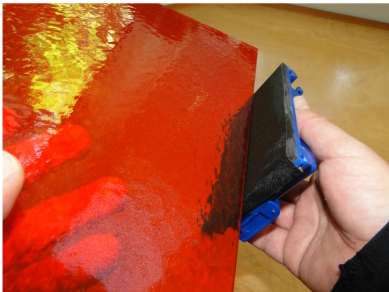
Nachdem Sie das Glas auf das gewünschte Maß zugeschnitten haben, säumen Sie die Kanten mit Naßschleifpapier ( 120iger Korn ).
