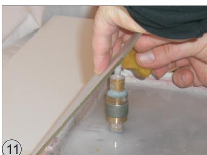
Mit dem Schwamm sorgen Sie für ausreichend Wasser-Zufuhr. Halten Sie die Scheibe schräg an den Schleifdorn. Arbeiten Sie mit nur mit ganz leichtem Druck.
