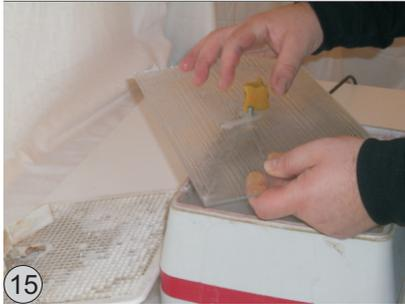
Schleifen Sie das Loch bis auf ca. 12mm Durchmesser. Ein 10mm Gewindestück muss später locker durch das Loch passen. Jetzt reinigen Sie die Scheibe.
