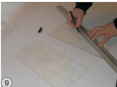
Für die mittlere Lochbohrung markieren die Scheibenmitte.
