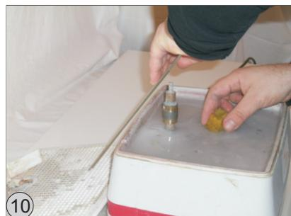
Das Loch bohren Sie mit einem Dorn-Aufsatz ( D=6mm ) für Ihre Schleifmaschine. Eine Glasbohr-Maschine funktioniert natürlich noch leichter ..
