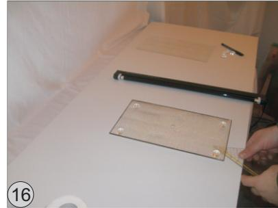
Kleben Sie kleine Füße unter die Scheibe. Optimal funktioniert UV-Kleber. Das Bild zeigt, wie Sie die Füße zunächst ohne Kleber positionieren.
