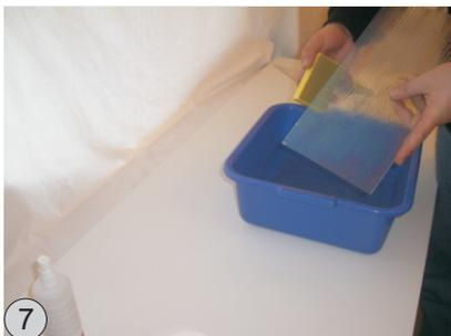
Wenn Sie die Scheibe nicht umlöten möchten, entgraten Sie die Kanten mit einem Schleifklotz. !! Schleifen Sie mit etwas Wasser ! nie trocken schleifen!!
