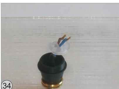
Als nächstes klemmen Sie die beiden Adern im Zugentlaster ein. Dieser verhindert, dass sich die Kabelenden aus der Fassung lösen können, sollte mal jemand am Kabel ziehen..
