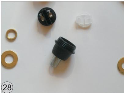
Zunächst schrauben Sie das Gewindestück (2417200) in den Sockel der Fassung ( 20 190 05 Fassung E14 )
