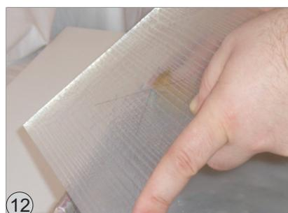
So schleifen Sie zunächst eine Kerbe ins Glas.. !! Die Schleifstelle immer mit viel Wasser versorgen !!
