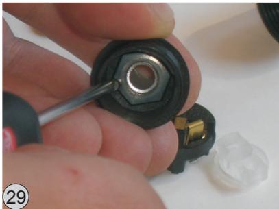
Die Sicherungsschraube stellen Sie fest. So kann sich die Fassung später nicht vom Gewinde lösen.
