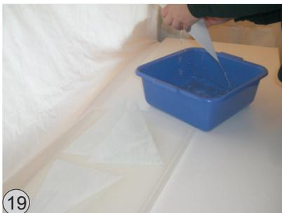
.. ganz wichtig .. waschen Sie die Glasteile nach dem schleifen mit Wasser ab - so reinigen Sie die Glasteile vom Schleifstaub bzw. Schleifschlamm.
