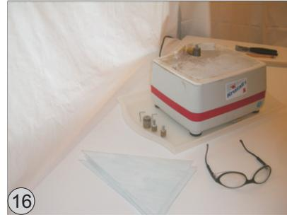
Im nächsten Schritt schleifen Sie die Teile mit einer Glasschleifmaschine. Achten Sie darauf, dass Sie mit genug Wasser schleifen. Der Schleifkopf darf nicht trockenlaufen.
