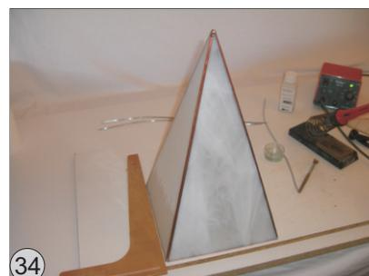
Prüfen Sie mit einem Winkel oder Geodreieck, ob die Pyramide unten rechteckig ist. Wenn nötig korrigieren Sie, dafür lösen und ändern Sie die gesetzten Lötspunkte.
