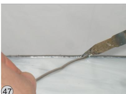
Abschließend ziehen Sie mit etwas Zinn die Naht sauber nach. Löten Sie nicht mit zu hoher Temperatur. In der Regel geben ca. 350°C ein schöneres Ergebnis als 400°C oder mehr..
