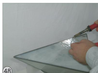
Ziehen Sie den LötKolben möglichst in einem Stück durch - ohne abzusetzen.. so wird die Lötnaht am gleichmäßigsten.
