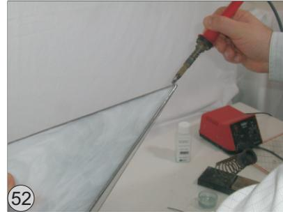
Abschließend passen Sie die Spitze an ( ohne zusätzlichem Lötzinn ) .. nur die Seiten an der Spitze kurz anschmelzen - so erhalten Sie einen sauberen Abschluss.
