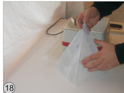
Aufgrund der Gehrung liegen die oberen Kanten der Seitenteile nun beim Aufbau näher zusammen, die Löt Nähte werden also automatisch schmaler.
