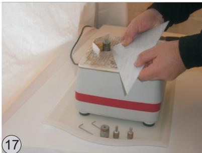
Schleifen Sie eine leichte Gehrung an die Längsseiten der Pyramidensegmente.
