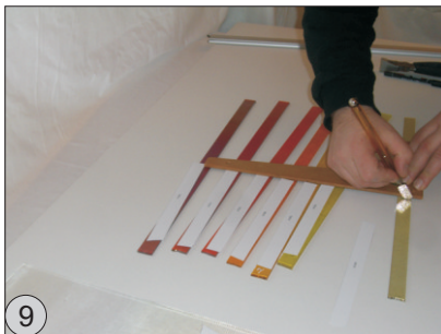
Passen Sie die Glasstreifen in der Länge grob der Schablone an ( Streifen ca. 2cm länger lassen als Schablone ).
