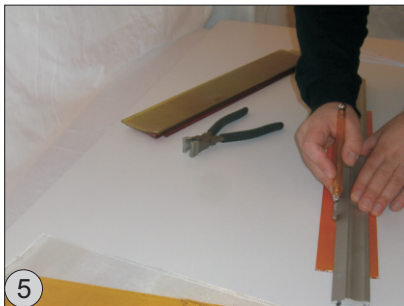
Schneiden Sie das Glas entlang eines stabilen Lineals. !! Am Lineal entlang führen Sie den Glasschneider zum Körper hin !!
