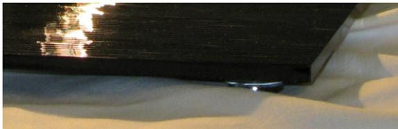
Die Glasscheibe kann umlaufend mit Kupferfolie eingefasst und umlötet werden - muss aber nicht. Wenn Sie die Scheibe sorgfältig geschnitten haben genügt ein leichtes Entgraten der scharfen Kanten ( vorzugsweise mit einem Schleifpad ).
