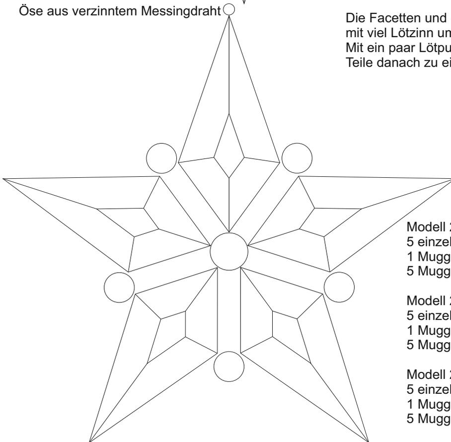
Die Facetten und der Muggelstein werden zunächst einzeln mit viel Lötzinn umlötet, so dass eine Art U-Profil entsteht. Mit ein paar Lötspitzen an den Schnittstellen setzen Sie die Teile danach zu einem Stern zusammen.
