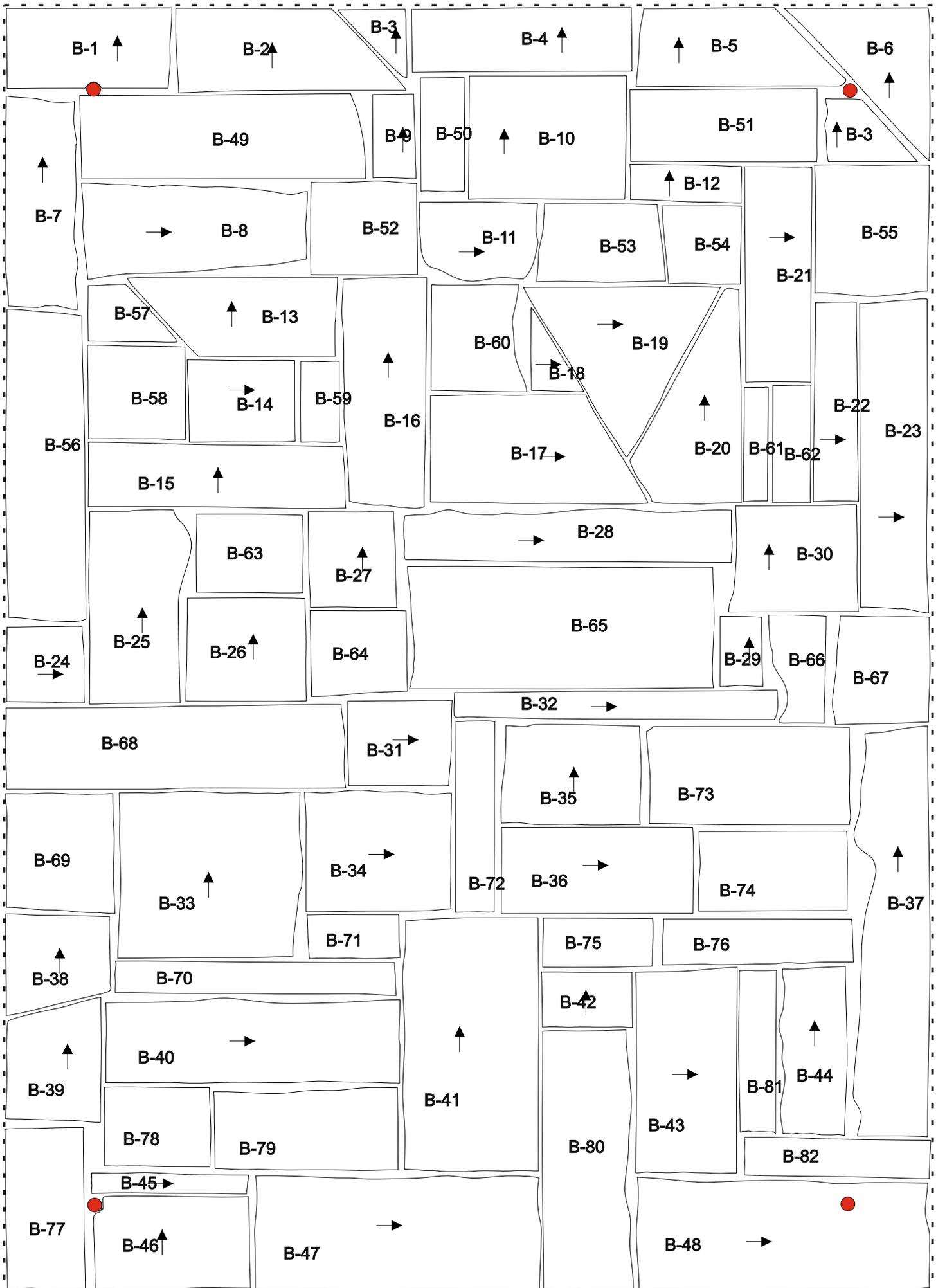
● = hier bleibt ein Loch mit ca. 6-7mm Durchmesser. Die insgesamt vier Löcher benötigen Sie später zur Montage des Glasbildes an der Wand.
